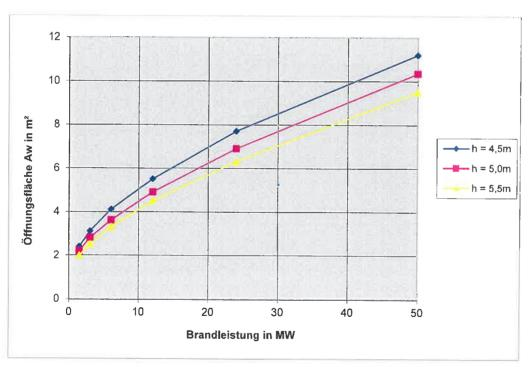
Mit der vorhandenen geometrischen Öffnungsfläche von 11,5 qm in der Tunneldecke, bzw. vertikal unmittelbar unter der Tunneldecke in Verbindung mit nur einem Anteil der Öffnungsflächen am Tunnelmund stehen ausreichend Öffnungsflächen in Relation zu den Anforderungen nach DIN zur Verfügung.
